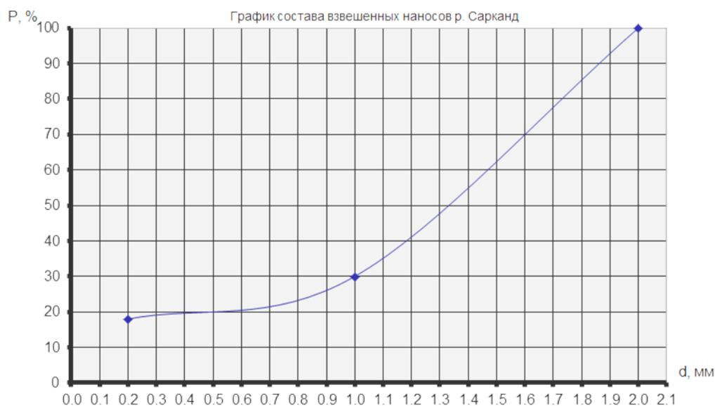
Рисунок 5 - График состава взвешенных наносов
