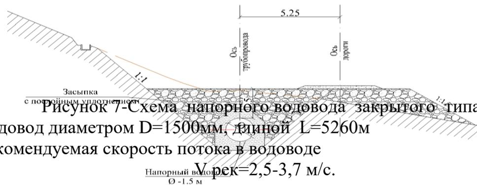
Наивыгоднейший диаметр трубопровода  $D_0$ , при напоре воды  $H=78,5 \text{ м}$  и расходе  $Q_{\text{max}}=4,5 \text{ м}^3/\text{с}$ .
